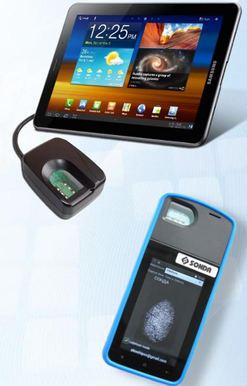
На экране терминала отображается качество отпечатка и время события. При отсутствии очередей сотрудников на экран может отобразиться результат идентификации (ФИО сотрудника).
